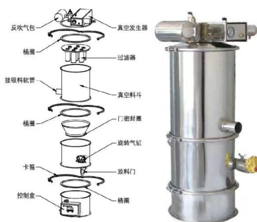
图 4-1 真空上料机结构示意图
